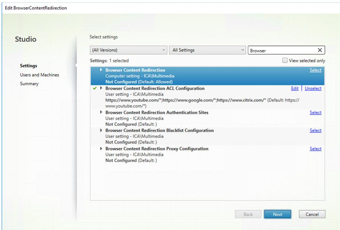
El parámetro **Configuración de lista ACL para redirección de contenido del explorador web** especifica una lista de direcciones URL que pueden utilizar la redirección de contenido de explorador.
